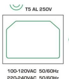
Tomada de entrada de energia (AC IN): Antes de ligar sua caixa, verifique a voltagem correta do local onde se encontra. Primeiro conecte o cabo de alimentação fornecido à caixa **MOUG MSDT 1000 PRO** e, em seguida, insira o plugue do cabo de alimentação na tomada (AC).
