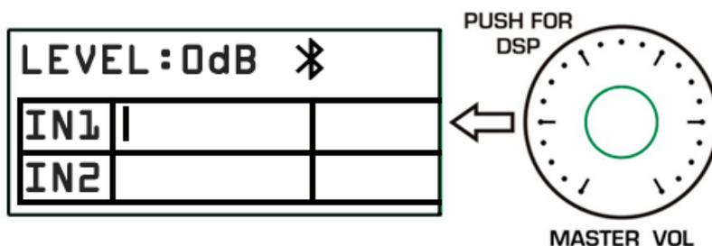
Pressione o interruptor do potenciômetro do codificador, o módulo entra na janela do menu de controle DSP da seguinte forma:
