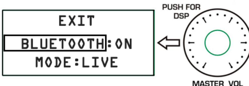
**Passo 2:** Clique no potenciômetro de codificação para entrar na opção de configuração de status do Bluetooth (veja a figura abaixo)
