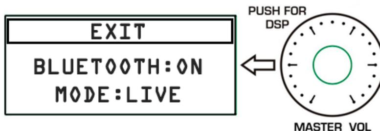
**Observação:** Quando o potenciômetro do codificador é girado no sentido horário, o cursor de seleção do menu se move para baixo; quando o potenciômetro do codificador é girado no sentido anti-horário, o cursor de seleção do menu se move para cima; o item destacado é a seleção atual e, em seguida, pressione o potenciômetro do codificador para entrar no modo de configuração da opção atual. Exemplo: Para definir BT para o modo TWS.
