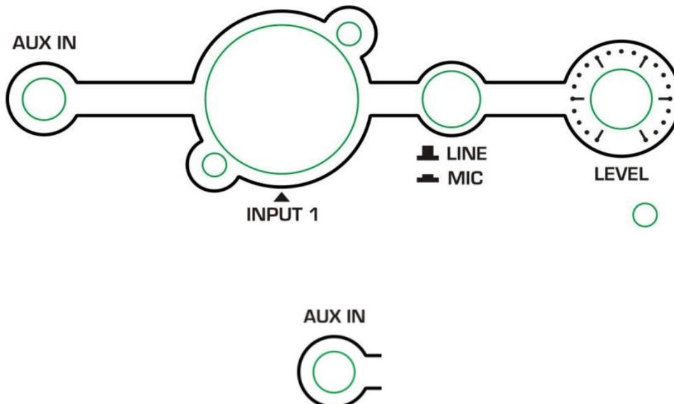
**AUX IN (ENTRADA AUXILIAR)** – Entrada para conector de áudio de 3,5 mm (P2) para conexão de dispositivos de mídia de áudio externos, como MP3 players
